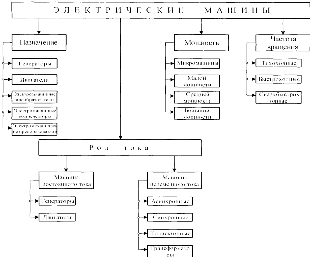
Рис.15.2 Классификация электрических машин
